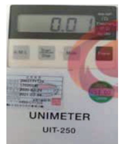
제품 Center 영역 조도값 측정 × 주변 영향으로 0.01은 오차 수치임
